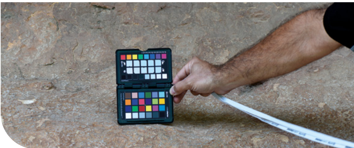
En plena era digital, las referencias colorimétricas han de obtenerse con procedimientos que permitan posteriormente un correcto procesado de espacio de color, para un fidedigna gama de colores. La tabla de color Checker Passport está siendo utilizada en arte rupestre. Foto MSN.
